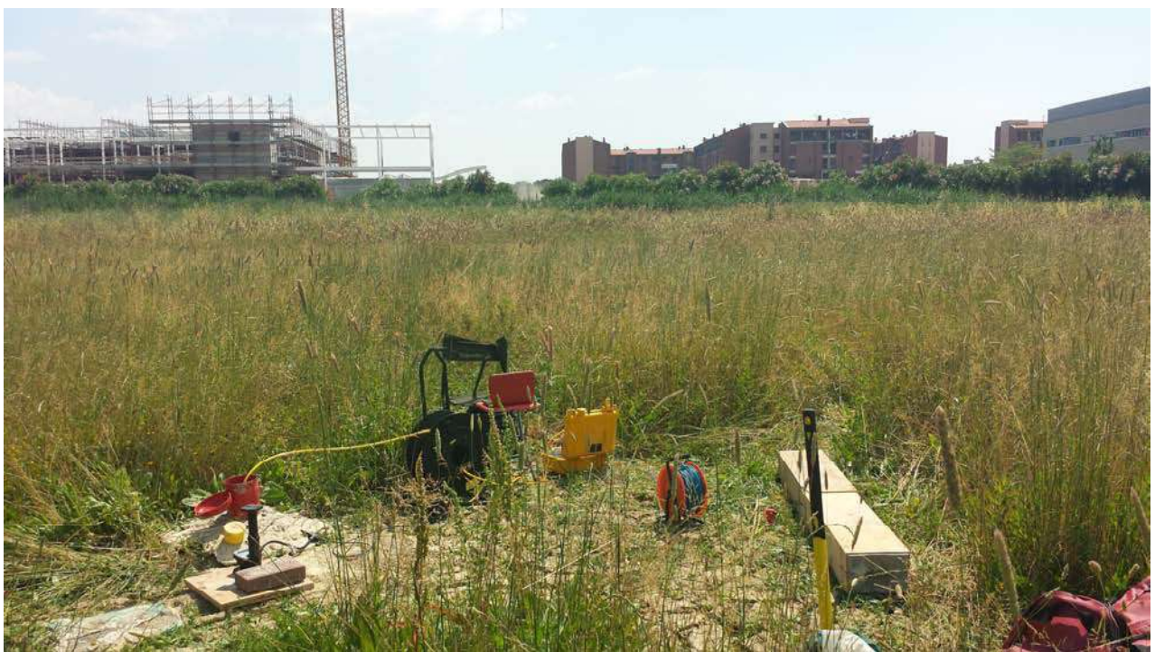
Fig. 4 – Sistema di energizzazione: mazza battente, piastra metallica e traversina in legno
